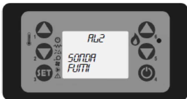
Intervine în cazul în care sonda de fum rezultă defectă. Soba intră în stare de alarmă, se aprinde ledul de alarmă (led alarmă aprins). Pe display va apărea mesajul “**AL 2 SONDĂ FUM**” (figura 21) iar soba se va opri. În acest caz resetați alarma apăsând tastă On/Off și contactați centrul de asistență autorizat.
